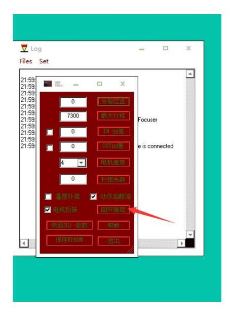
上图中重启固定件,专门为远程用户设置。 上图中,温度补偿,回差您视具体情况而定。一般不用设置。 电机速度就建议使用 4 前面的设置是按实际情况操作,好了后点 CONNECT 就行了。
